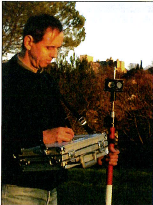
Figure 350. La tablette graphique se porte facilement et libère le porte-prisme © Cabinet Vacher
