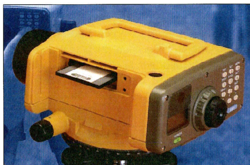
Figure 348. Enregistrement des données de nivellement dans le DL101C © Topcon
