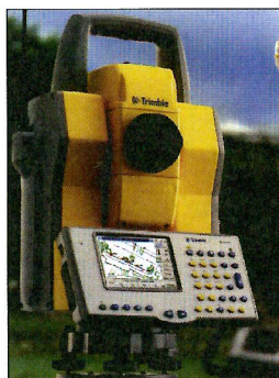
Figure 346. Tachéomètre équipé d'un écran graphique. On peut y intervenir au moyen d'un stylet. La codification se vérifie immédiatement ! © Trimble
